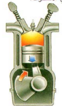
3 شُوطُ القُدْرَةِ: تُشْعَلُ شَرَارَةُ مَزِيْجِ الوَقُوْدِ وَالهَوَاءِ فَيَشْتَعَلُ المَزِيْجُ مُتَفَجِّرًا دَافِعًا الكِبَاسَ سَفَلًا بِقُوَّةٍ.
