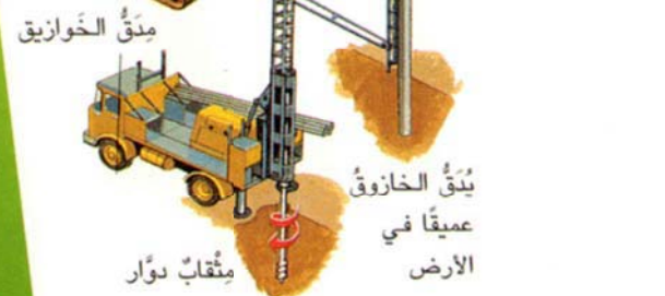
مِدَقُ الخوازيق يُدَقُّ الخوازيق عميقاً في الأرض بِمِقَابِ دَوَّارِ رِكَائِزِ (خوازيق) الأساس يُمكن نَقْها إلى عَمَقِ حِوَالِي 100 مِتر بِطَرِيقِ الخوازيق كَثَرَا بِثِقَلِ يَدْفَعُه في الأرض. الرِكَائِزُ الخَرَسَانِيَّةُ يُمكن صَبُّها في ثُقُوبِ تَحْفَرُها مَنَاقِبُ نَوَّارَة.
