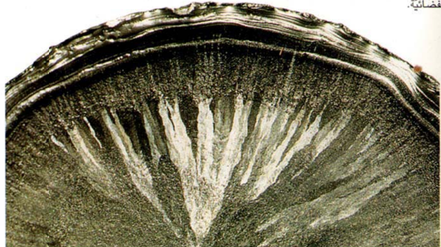
▼ الصورة الفوتوغرافية هذه تُبين مقطعاً عرضياً لأسطوانة مصنوعة من سبيكة التيتانيوم والألومنيوم. وهي واسعة الاستعمال في صناعة المركبات الفضائية.
